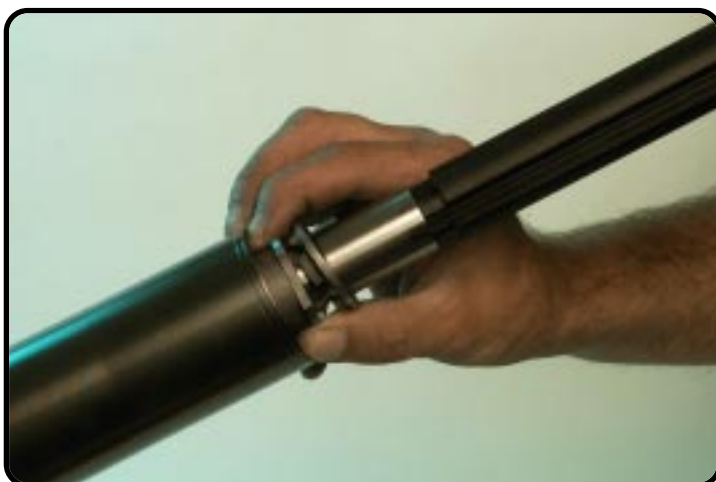
Patrone in Federbein einsetzen.
