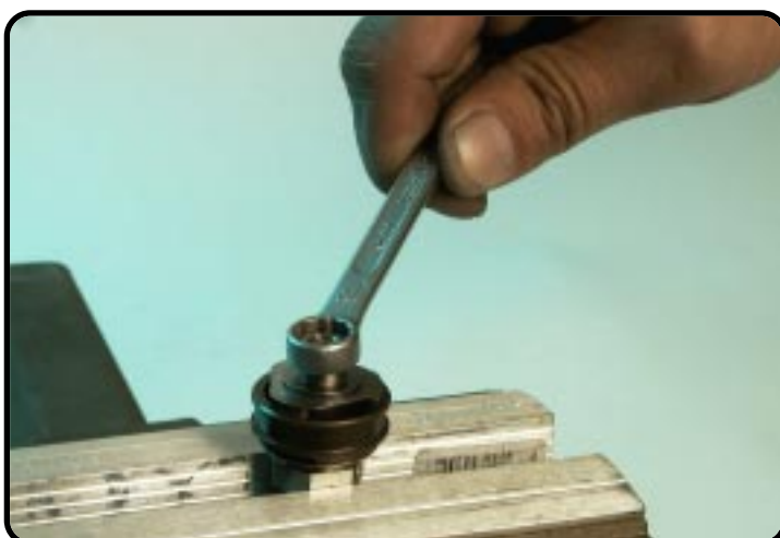
Auf Stellung Dreieckscheiben achten!!! Zugstufenaufnahme in Schraubstock einspannen und Mutter mit Schlüssel 10 lösen. Bei Bautypen mit Sicherung ist diese zuerst zu entfernen, beispielsweise mit einer Feile.
