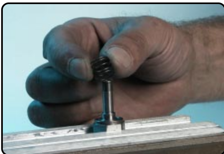
Feder Rückschlagventil entfernen.
