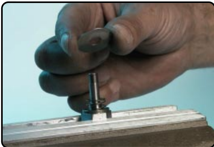
Scheibe(n) Rückschlagventil entfernen.
