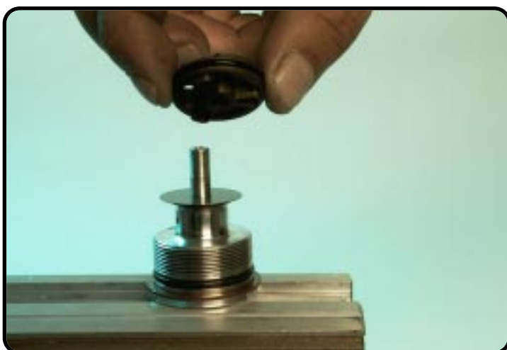
Kolben mit O-Ring entfernen. Montagerichtung beachten!!!
