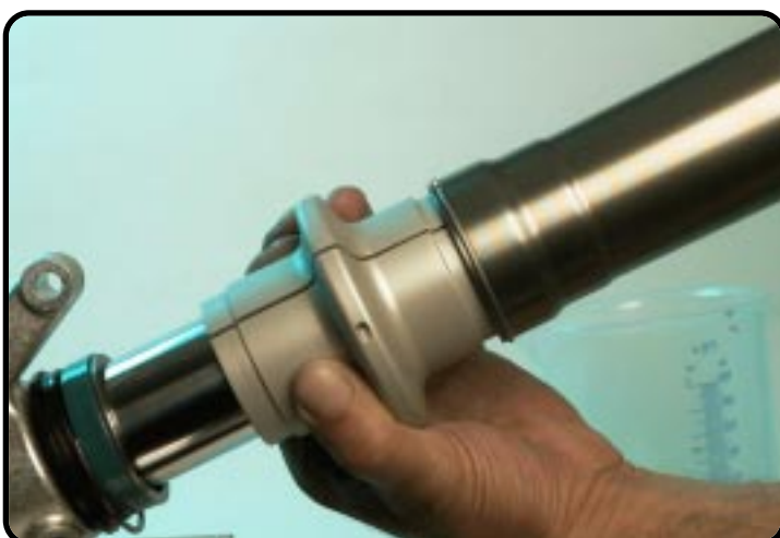
...in Außenrohr klopfen oder drücken.
