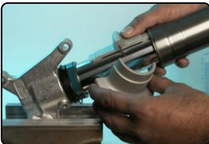
Führungsbüchse Außenrohr mit flacher Seite von (4357) T502S / (4860) montieren...
