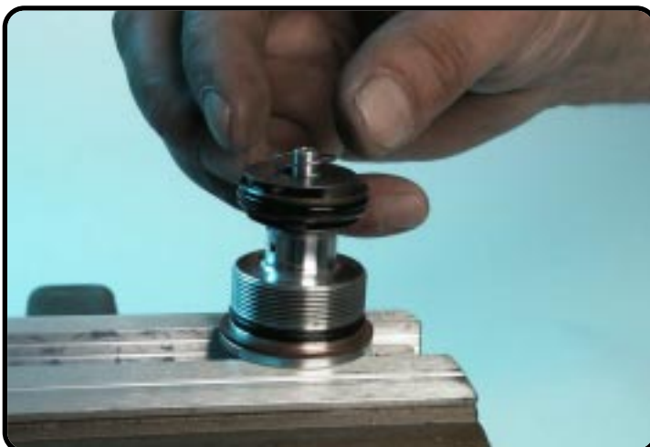
Feder Rückschlagventil einsetzen. Montagerichtung beachten!!!
