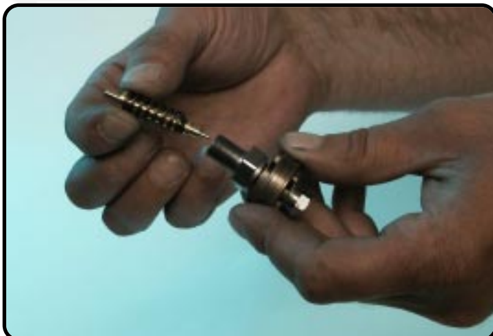
Nadel mit Feder aus Zugstufenaufnahme nehmen.
