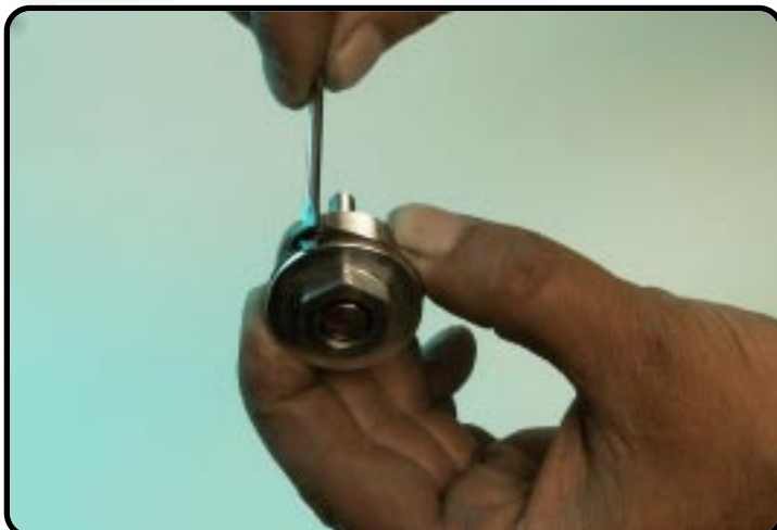
O-Ring Druckstufenaufnahme entfernen.
