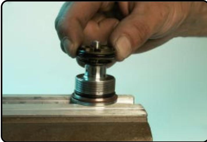
Kolben einsetzen. Montagerichtung beachten!!!
