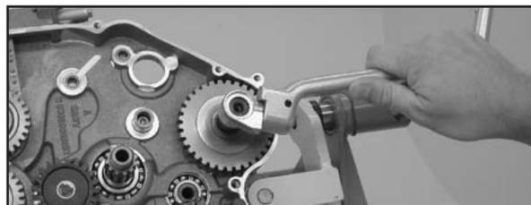
Erst wenn der Kickstarter im Uhrzeigersinn betätigt wird, greift der Mitnehmer ein, das Kickstarterrad sperrt bei Drehung gegen den Uhrzeigersinn.
