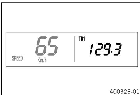
– Taste **0** so oft kurz drücken, bis die Anzeige **TR1** rechts oben im Display erscheint. Der **TR1** (Tripmaster 1) läuft immer mit und zählt bis 999,9.
