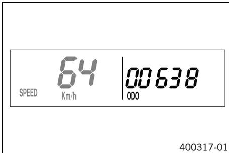
– Taste **0** so oft kurz drücken, bis die Anzeige **ODO** rechts unten im Display erscheint. Im Anzeigemodus **ODO** werden die gefahrenen Kilometer angezeigt.
